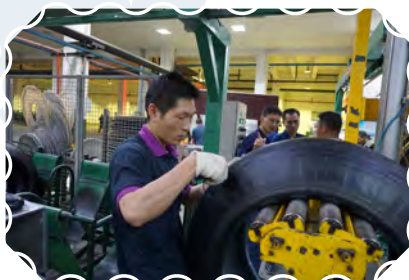
成型工正在技能比武现场检测胎胚冠部
